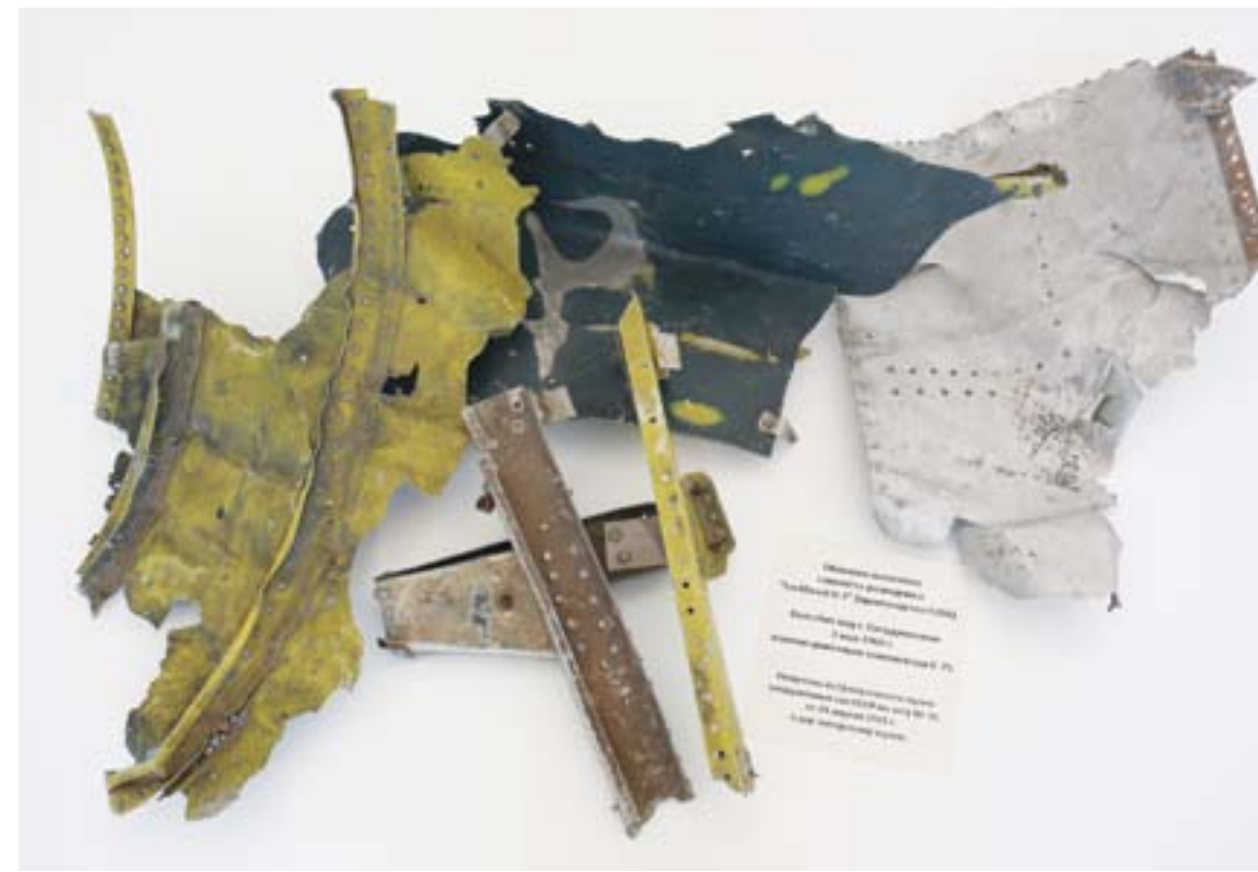
В выставочной экспозиции ЗиКа представлены фрагменты «Lockheed U-2» - алюминиевые листы обшивки фюзеляжа и части лонжеронов. Их предприятию в 1974 году передал Центральный музей Вооруженных Сил СССР
